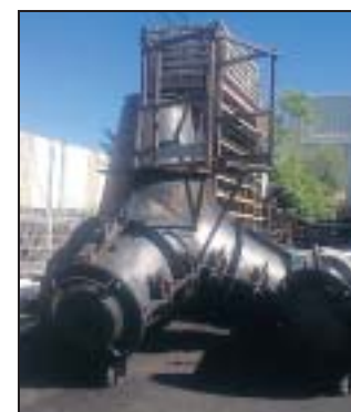
Ce coffrage de tétrapode a été réalisé à La Réunion.
